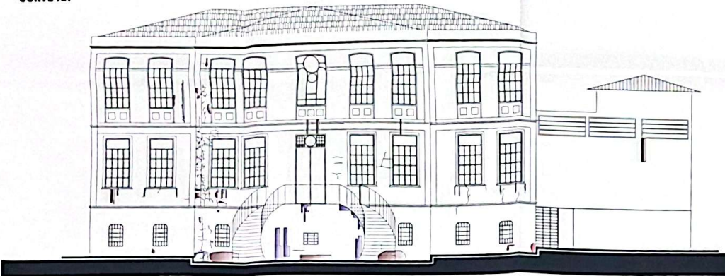
MAPA DE DANOS FACHADA PRINCIPAL: RUA SÃO BENTO
