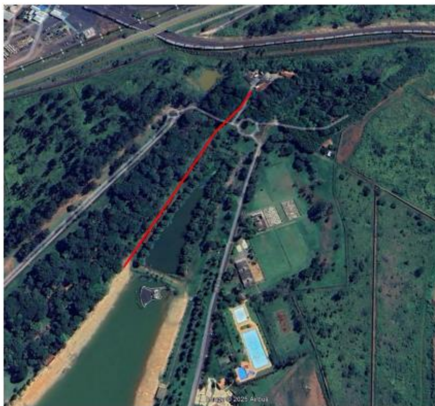
Figura 5 – Tubulação a ser substituída por 150 mm
