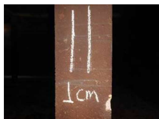
Detalhe do ensaio de pacometria em pilar da câmara 2
