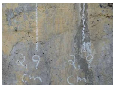
Detalhe do ensaio de pacometria em parede e pilar da câmara 2
