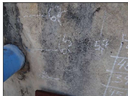
Detalhe do ensaio de pacometria em parede e pilar da câmara 1 e 2
