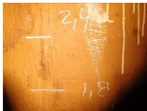
Detalhe do ensaio de pacometria em parede e pilar da câmara 2
