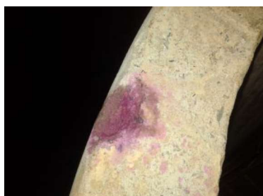
Vista da aspersão da solução de fenolftaleína em parede interna e pilar externo
