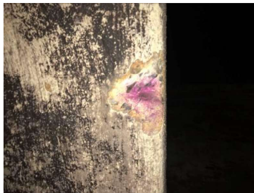
Vista da aspersão da solução de fenolftaleína em pilares das câmaras 1 e 2
