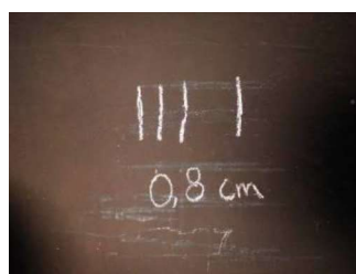
Detalhe do ensaio de pacometria em parede da câmara 1
