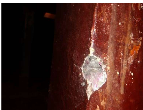
Vista da aspersão da solução de fenolftaleína em pilar do Reservatório
