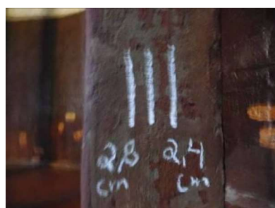
Detalhe do ensaio de pacometria em parede e pilar da câmara 1
