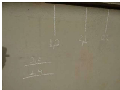
Detalhe do ensaio de pacometria em pilar da câmara 1
