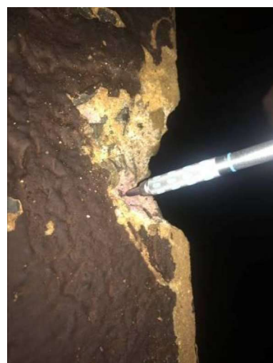
Vista da aspersão da solução de fenolftaleína em pilares das câmaras 1 e 2
