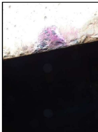
Vista da aspersão da solução de fenolftaleína na parede
