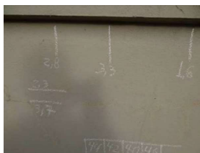
Detalhe do ensaio de pacometria em pilar da câmara 2
